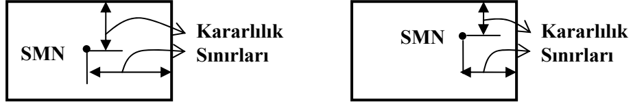
Şekil 4.16: Sıfır Moment Noktasının Yeri ve Kararlılık Sınırları
